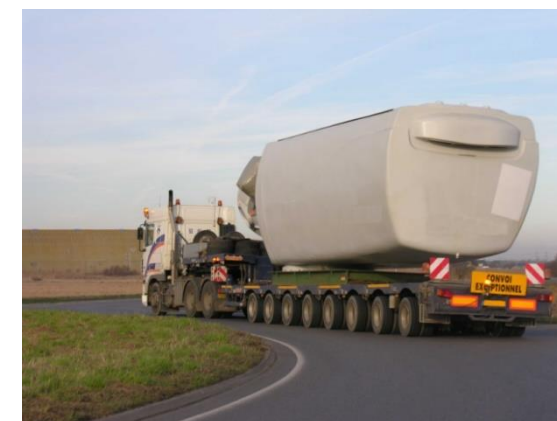
Transport de la nacelle
